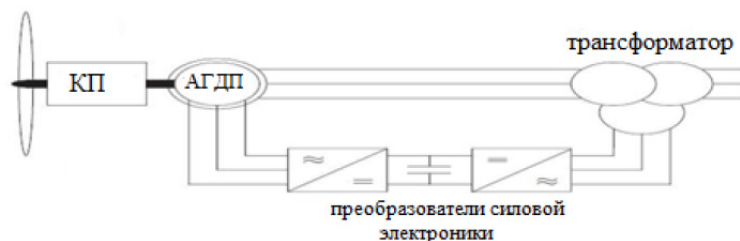
КП – коробка передач; АГДП – асинхронный генератор с двойным питанием
