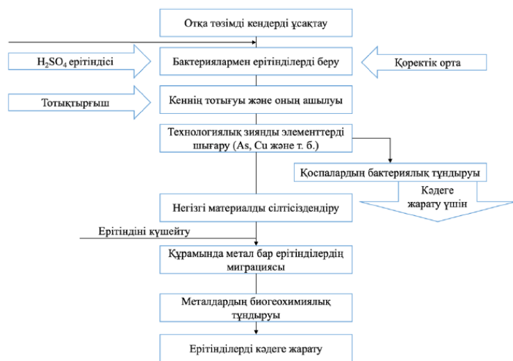
Сурет 2 – Au (алтынның) бактериялық сілтісіздендірудің технологиялық схемасы
